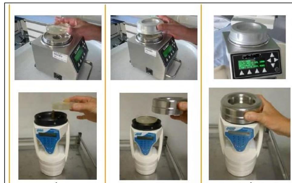
*Figura 2 Strumenti per il monitoraggio della contaminazione microbica aerodispersa; Fonte: "Surveillance microbiologique de l'environnement dans les ES – CCLIN Sud-Ouest – 2016".*
