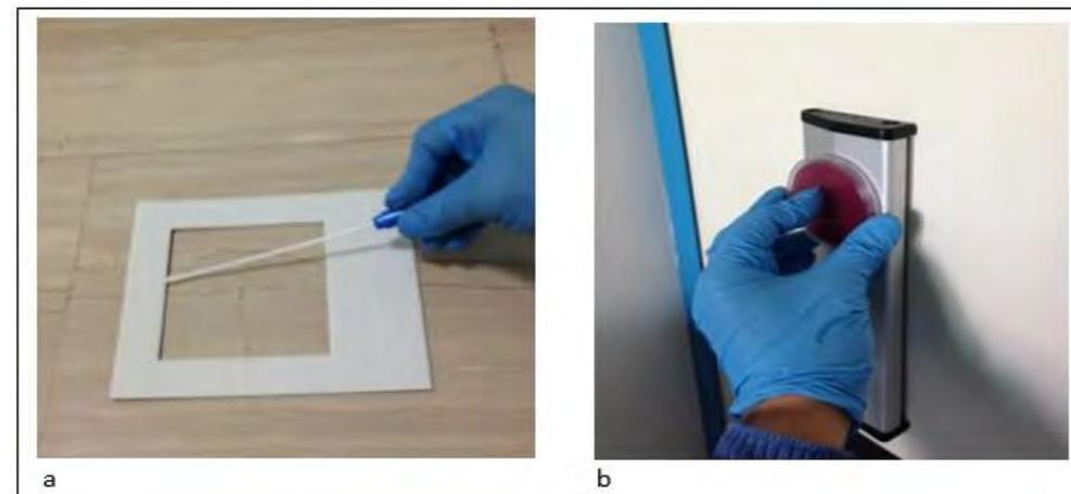
Figura 3 a) Tecnica di campionamento con tampone, b) Campionamento mediante RODAC (Replicate Organism Direct Agar Contact).
