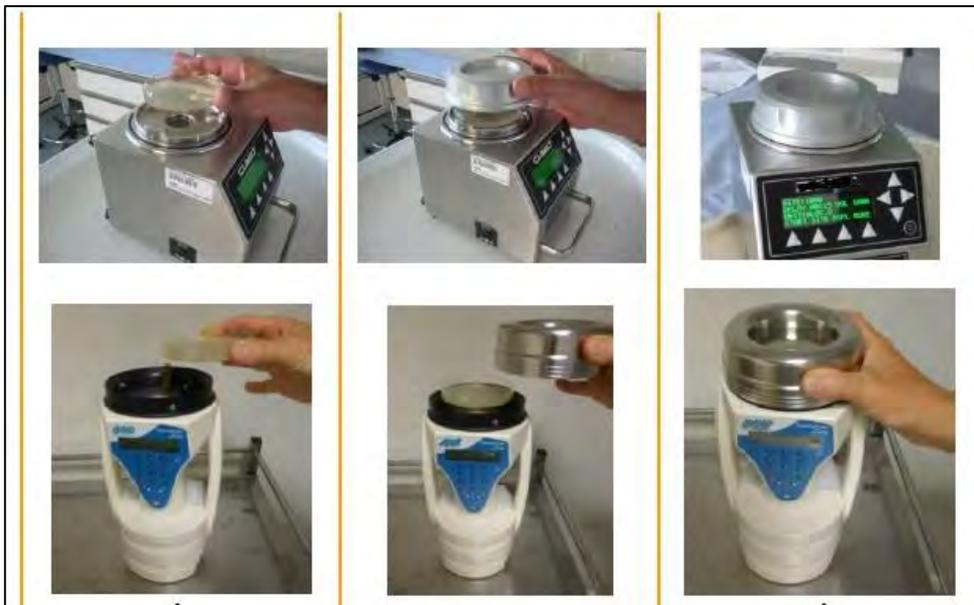
Figura 2 Strumenti per il monitoraggio della contaminazione microbica eorodispersa; Fonte: “Surveillance microbiologique de l’environnement dans les ES – CCLIN Sud-Ouest – 2016”.
