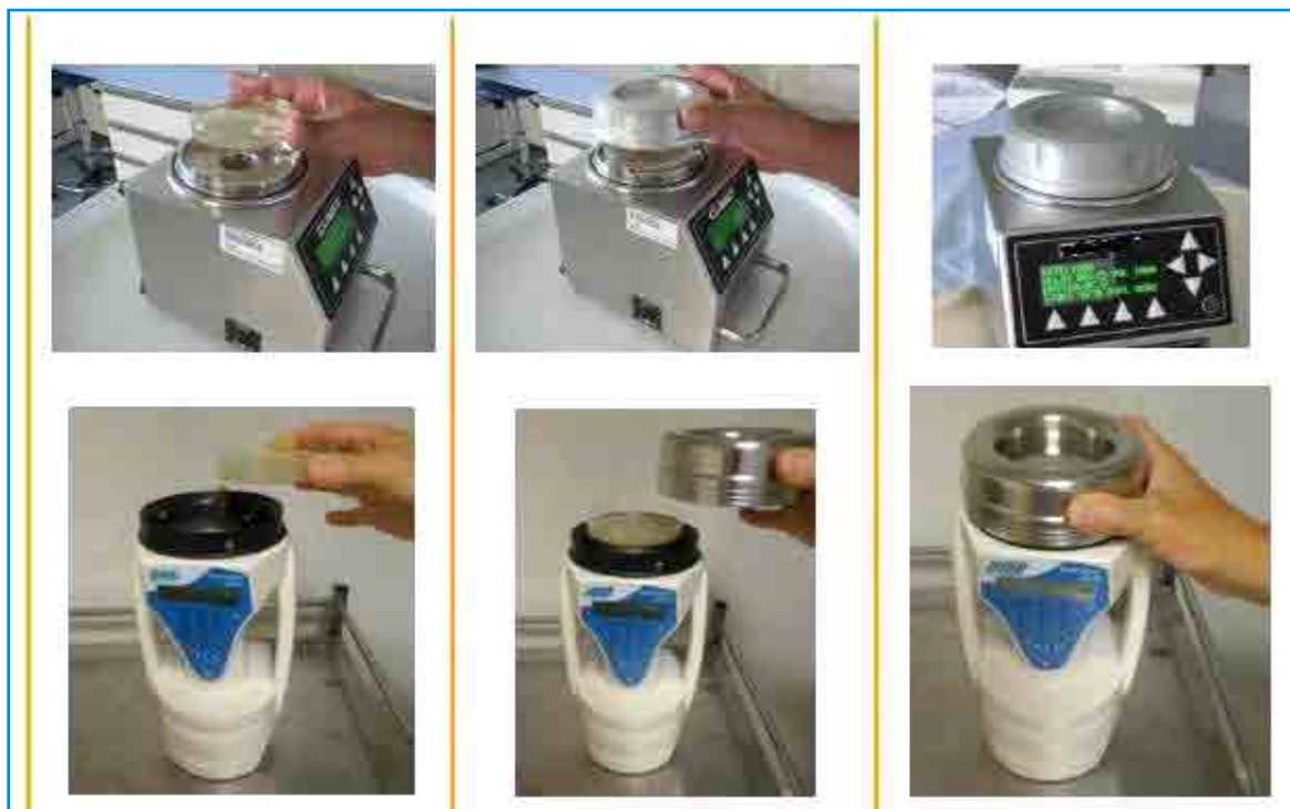
Figura 2 – Strumenti per il monitoraggio della contaminazione microbica eorodispersa; Fonte: “Surveillance microbiologique de l’environnement dans les ES – CCLIN Sud-Ouest – 2016”.
