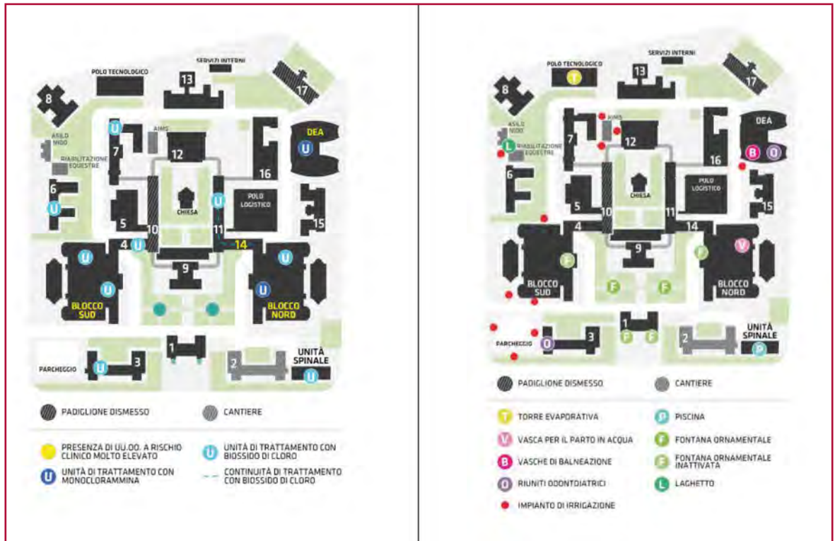
Figura 3 – Distribuzione delle unità di trattamento con biossido di cloro e monoclorammina e degli ‘Altri impianti idrici’
