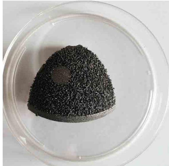
Fig. 6.2 Dark grey provino (specimen) diametro medio dei pori di ca 400u
