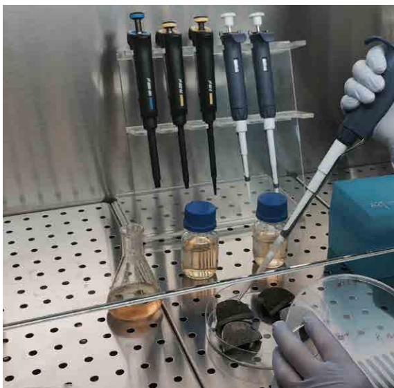
Fig. 12 In laboratorio: i provini test durante l'inoculo microbico eseguito sotto cappa Biohazard.
