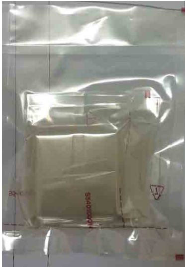
Fig. 4: provini in confezione (triplice involucro) sterilizzati prima del test microbiologico
