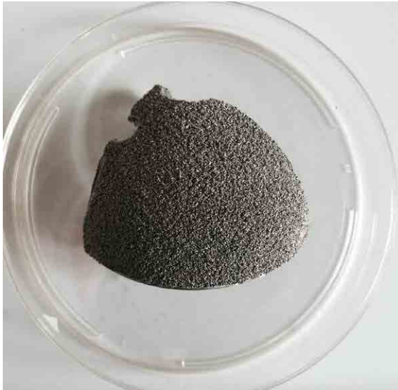
Fig. 6.1 Light grey provino (specimen) diametro medio dei pori di ca 300u
