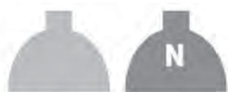
Esempio di vecchia e nuova colorazione distintiva per bombole contenenti anidride carbonica.
