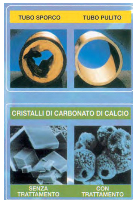
Figura 1. "Fenomeni di incrostazioni delle linee idriche"
