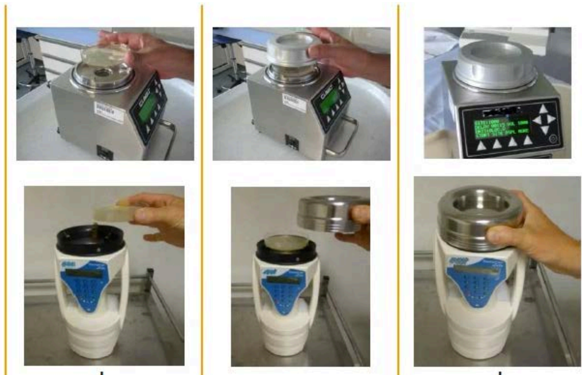
FIGURA 2 STRUMENTI PER IL MONITORAGGIO DELLA CONTAMINAZIONE MICROBICA EORODISPERSA; CAMPIONATORI ATTIVI.
