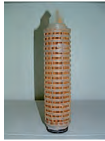
Immagine 3: cartuccia sistema filtrante, dopo un mese di utilizzo.
