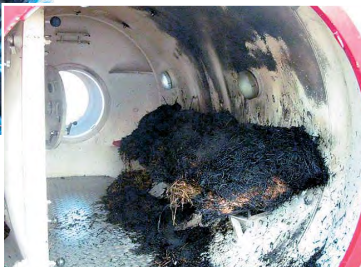
Foto 10 - Prova nr. 6 > 36% - Danni
